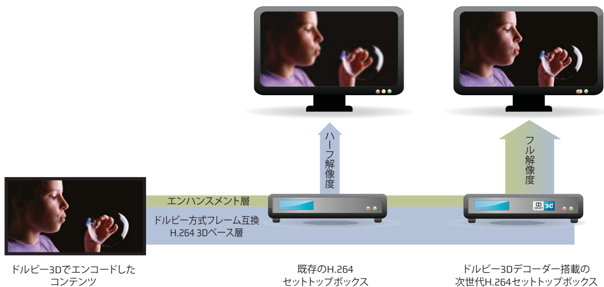
図3 Dolby 3Dによるデコードと、従来のシステムとの互換性
